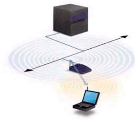
Figura 4. Utilización de un *Punto de acceso*
