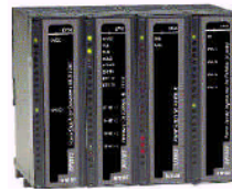
Device Link H1 - HSE con I/O locales
